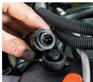
Cavo segnale, 7 poli
